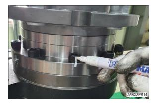
(12) Fasten socket-head bolt (1).  $\cdot$  Fastening torque : 9  $\pm$  0.5 kgf  $\cdot$  m
